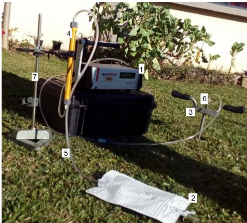
Figura 15: Equipamentos componentes para a medição de radônio: (1) Monitor AlphaGUARD; (2) Balão de ar; (3) Haste metálica pra inserir a sonda no solo; (4) Rotâmetro; (5) Mangueira de conexão; (6) Sonda; (7) Haste metálica
