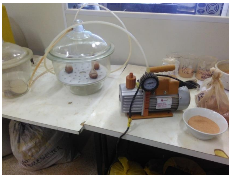
Figura 21: Equipamento para aplicação do vácuo Fonte: Autoria própria
