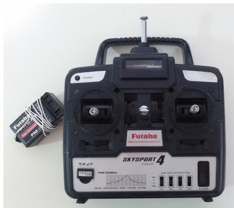
Figura 18: Conjunto transmissor/receptor do fabricante Futaba
