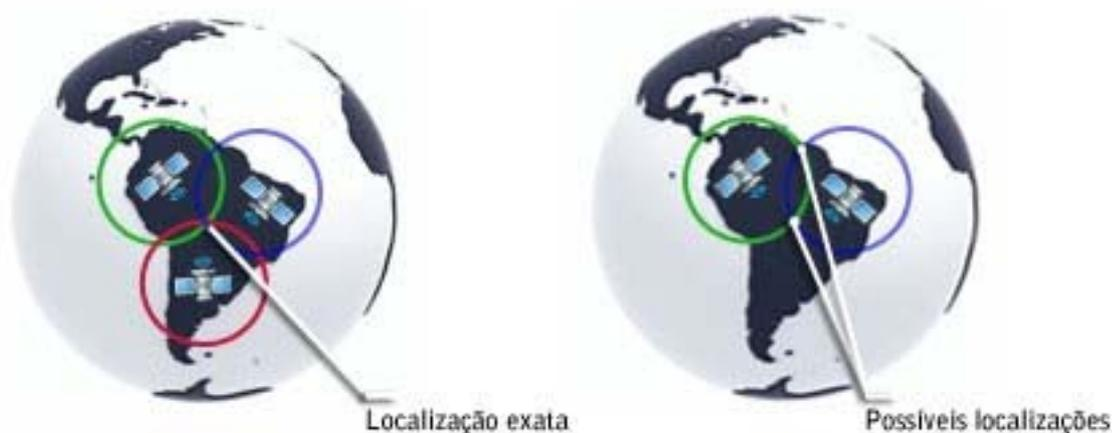
**Figura 9 – Triangulação com três e dois satélites**
