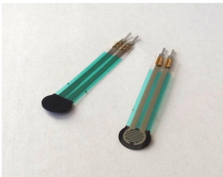
Figura 5 – Sensores *FSR* (frente e verso)
