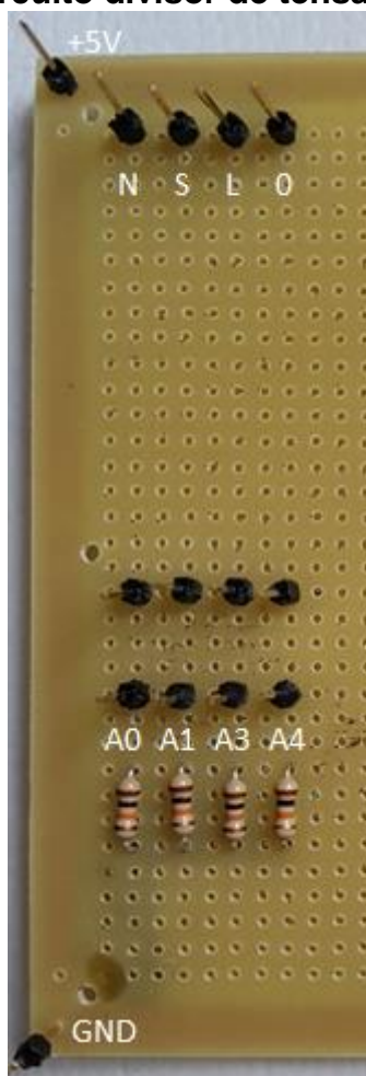
Figura 46 – Circuito divisor de tensão para os LDR.
