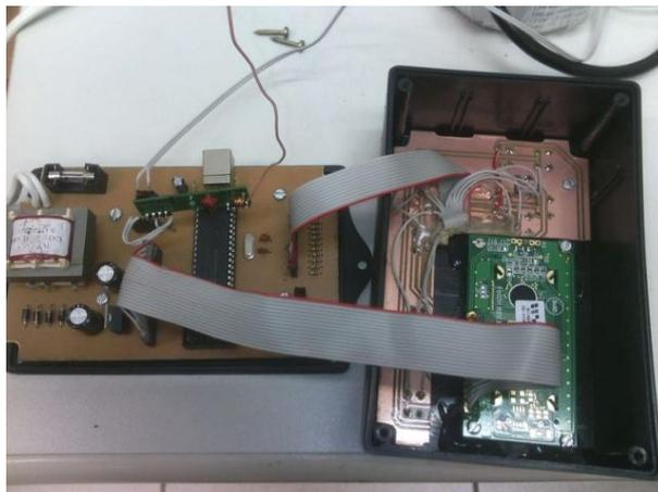
**Figura 19 – Placas da interface humano-máquina**
