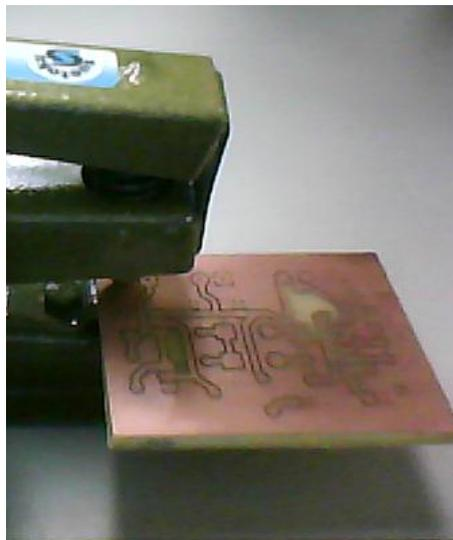
**Figura 4 – Placa de circuito impresso sendo furada**
