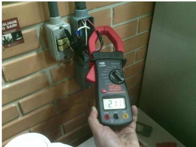
**Figura 32 – Medição de corrente final**
