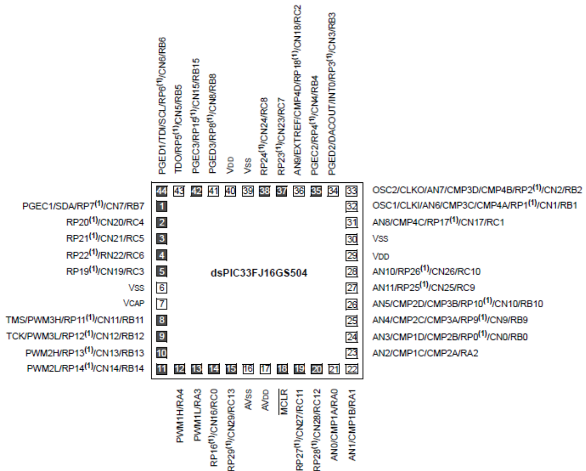
Figura 29 - Pinagem simplificada do dsPIC33FJ16GS Fonte: Microchip (2011).
