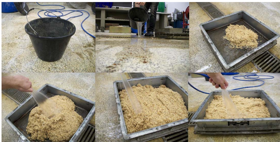
Figura 4 - Processo de Lavagem do Resíduo de Madeira
