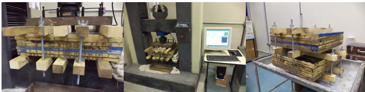
Figura 9 - Prensagem e Grampeamento das Fôrmas
