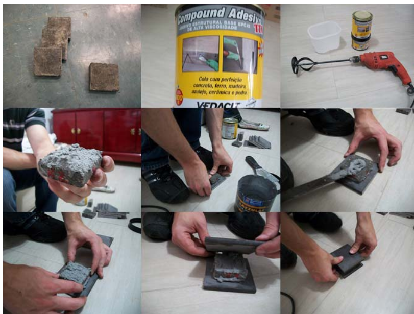
Figura 14 - Preparo dos corpos de prova para o ensaio de Ligação Interna
