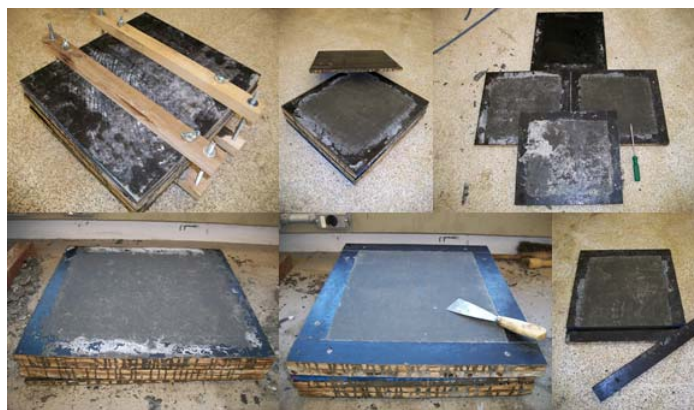
Figura 10 - Desfôrma das Placas
