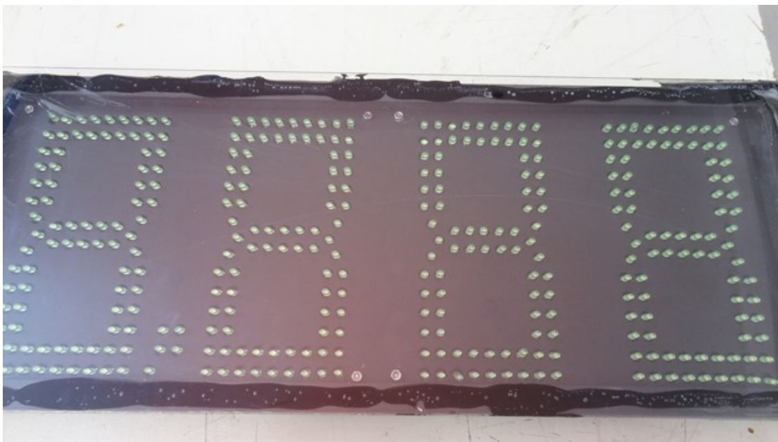
Figura 13 - Display de Leds completo com a máscara
