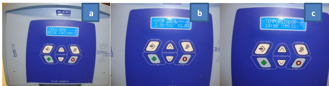
Figura 8 – Ajuste de parâmetros do ultrassom nos testes de calibração no Laboratório da UTFPR. (a) Modulação: feixe contínuo; (b) ajuste da intensidade: 2,8 W/cm 2 e 42 W; (c) ajuste do tempo da aplicação.
