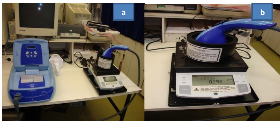
Figura 7 – Testes de calibração do equipamento de Ultrassom Avatar Cuatro (a) no laboratório da UTFPR, utilizando balança ultrassônica (b) da Ohmic Instruments (ULTRASOUND POWER METER MODEL UPM-DT-1).
