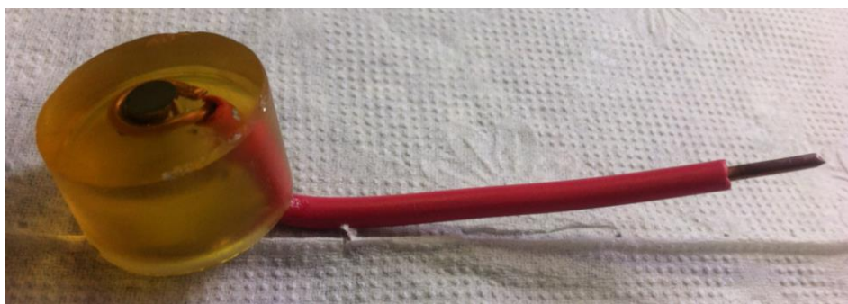
Figura 3.2 – Foto do eletrodo de trabalho em que uma amostra de aço inox 304 foi embutida em resina de poliuretana.
