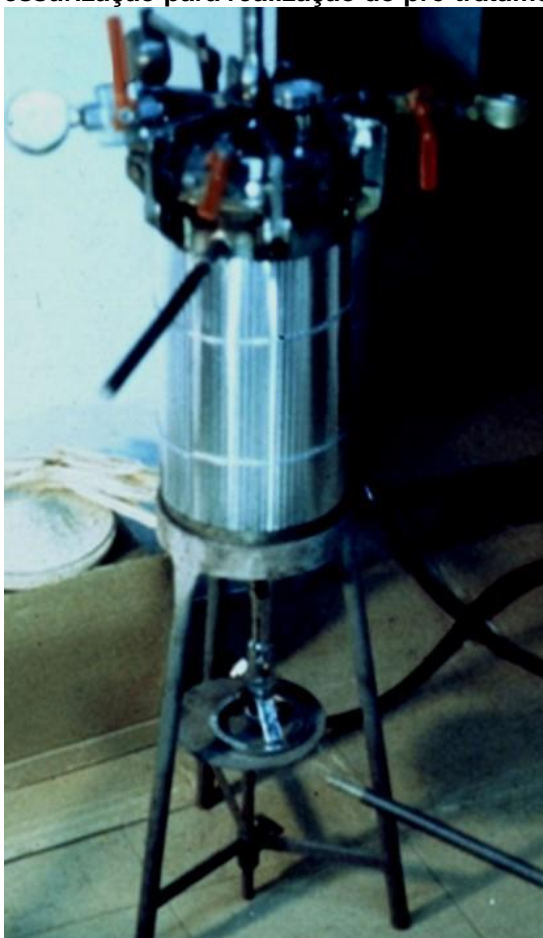
Figura 10 – Reator de Termopressurização para realização do pré-tratamento fosfórico.
