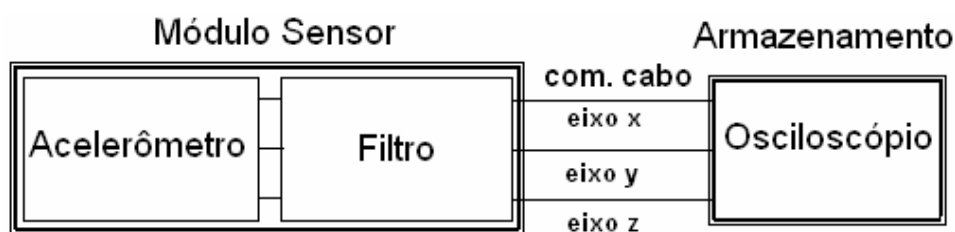
Figura 20 - Dispositivos utilizados no primeiro experimento para a captura e armazenamento dos dados nos três eixos ortogonais.
