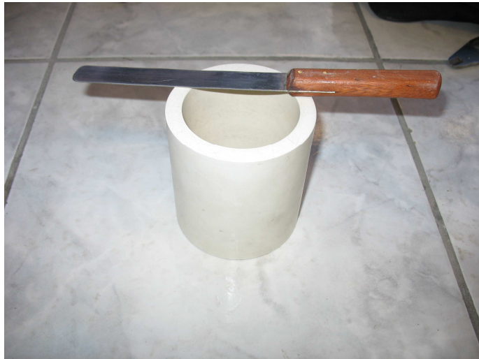
Figura 3.2 – Recipiente para determinação da densidade de massa da argamassa
