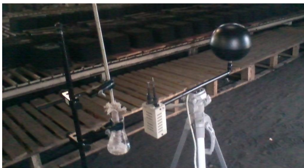
Figura 7 – Árvore de IBUTG e Confortímetro Senu® posicionados no ponto 1 de medição Fonte: Autoria própria
