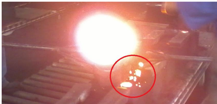
Figura 8 – Formação de respingos (no interior da circunferência em vermelho) durante vazamento Fonte: Autoria própria
