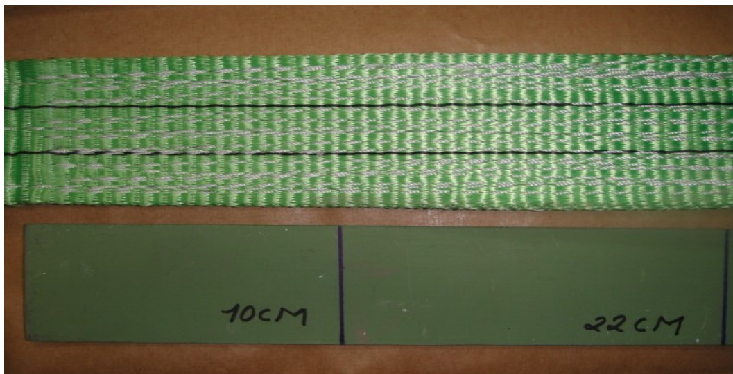
Figura 21 – O gabarito de marcação mostra que o transpasse possui comprimento correto Fonte: Os Autores (2016).
