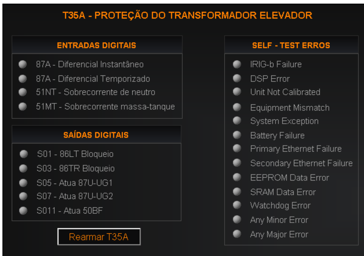
Figura 34 - Proteções do Transformador Elevador
