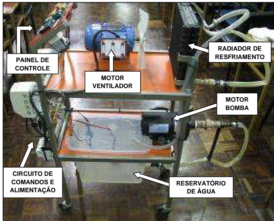
Figura 13 – Torre de Resfriamento de Água (bancada acadêmica) Fonte: Autoria Própria
