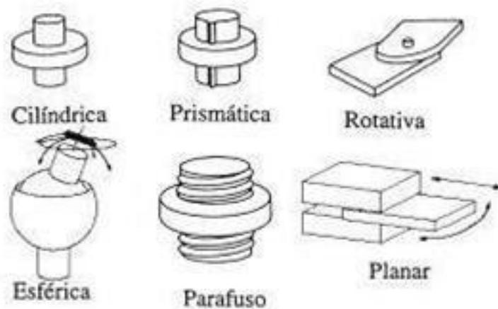
**Figura 12 - Tipos de junta utilizadas em robôs industriais**
