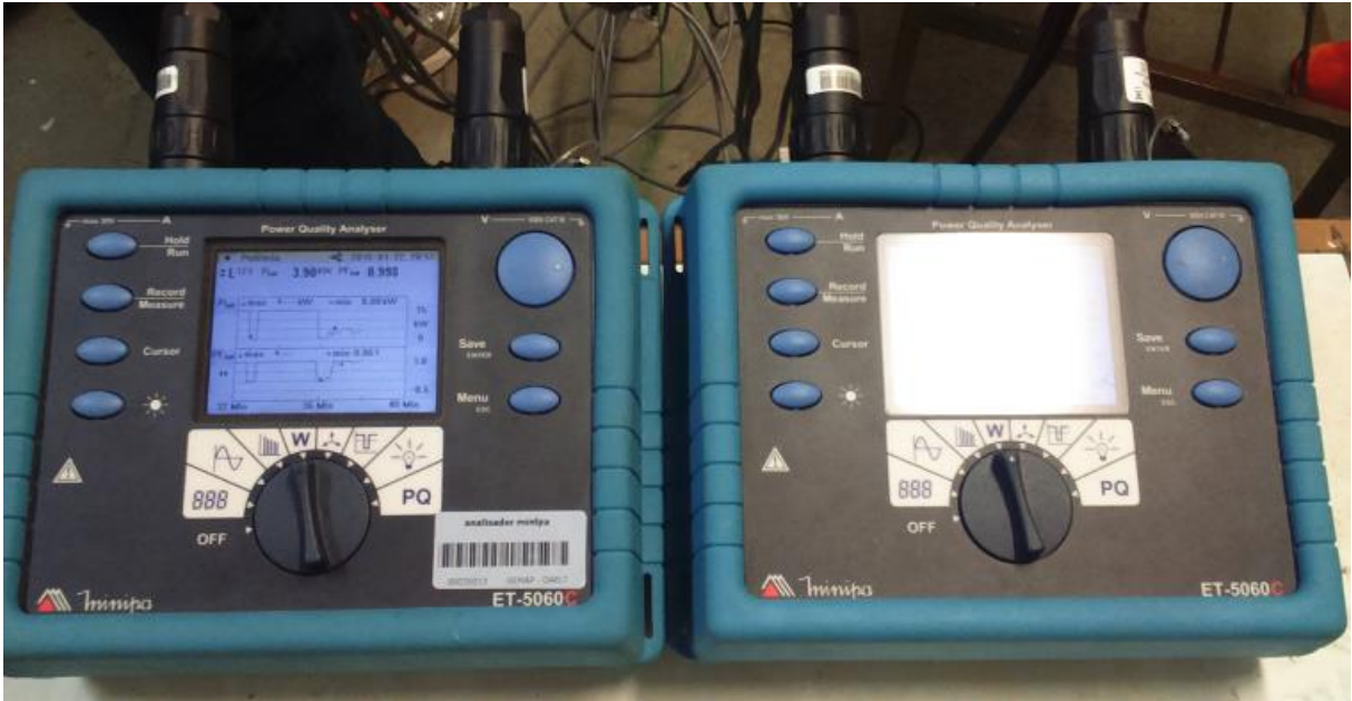
Figura 26 Analisadores de energia monitorando os GMGs Fonte: Autor (2015)
