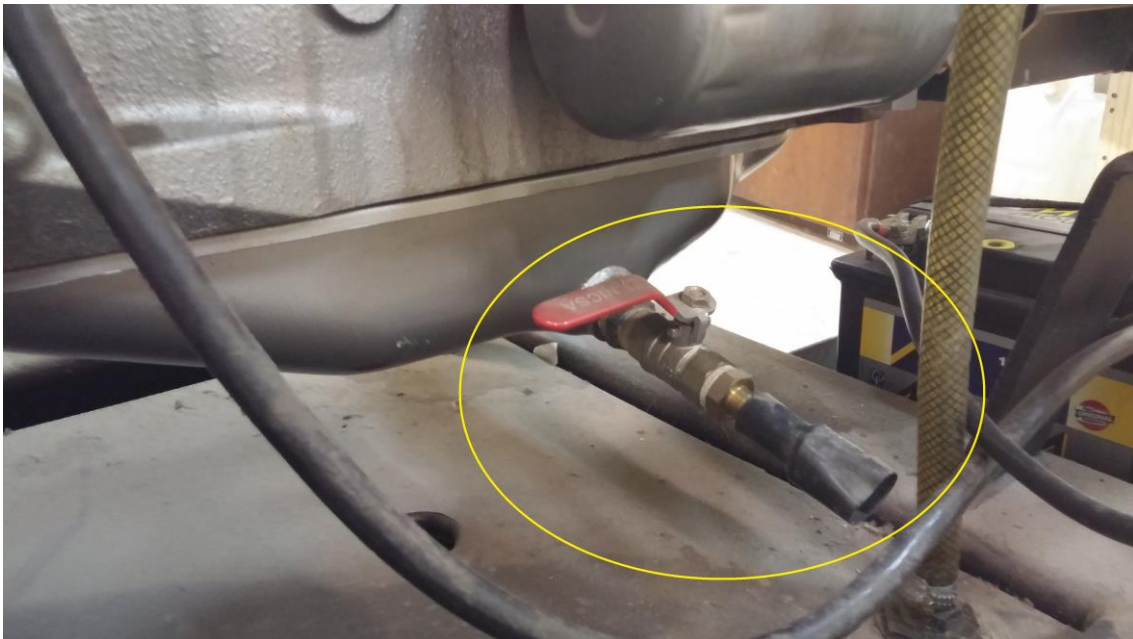
Figura 54 - Registro para drenar óleo lubrificante do motor
