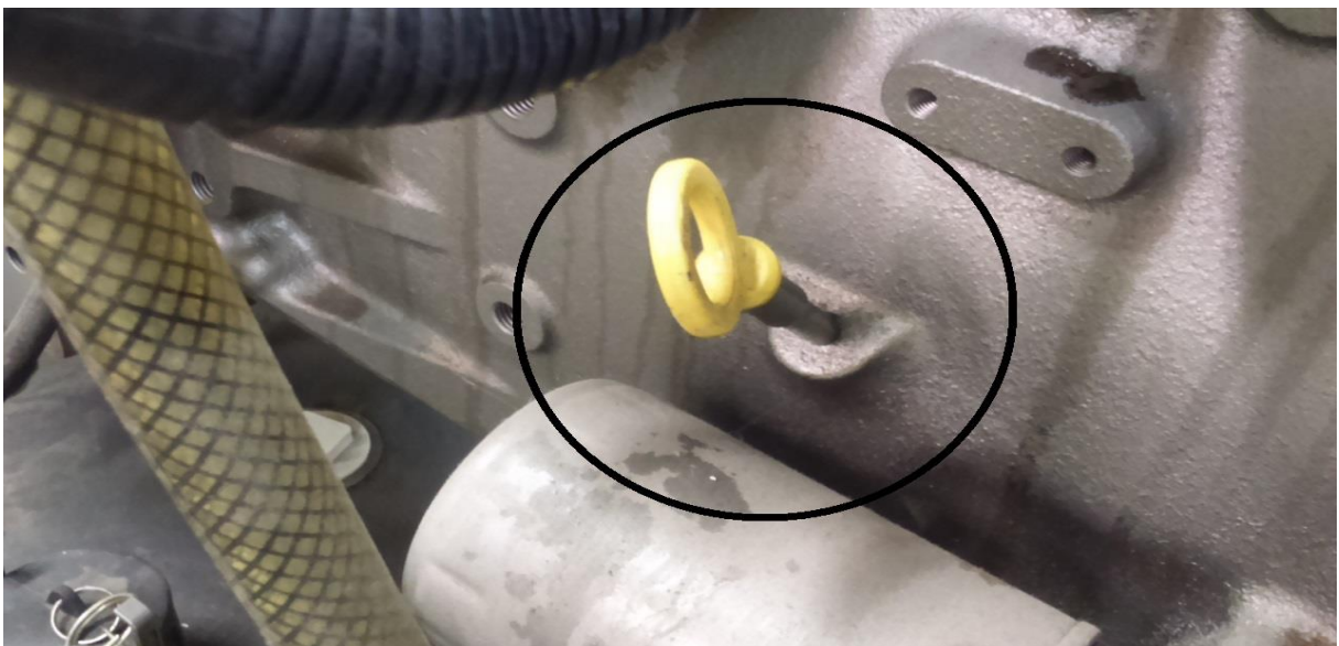
Figura 34 - Vareta de inspeção do nível de óleo lubrificante Fonte: Autor (2015)
