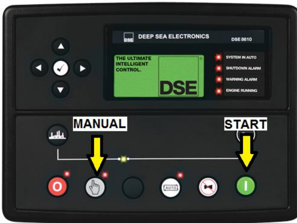
Figura 43 - Módulo DSE indicando as teclas MANUAL e START Fonte: Autor (2015)
