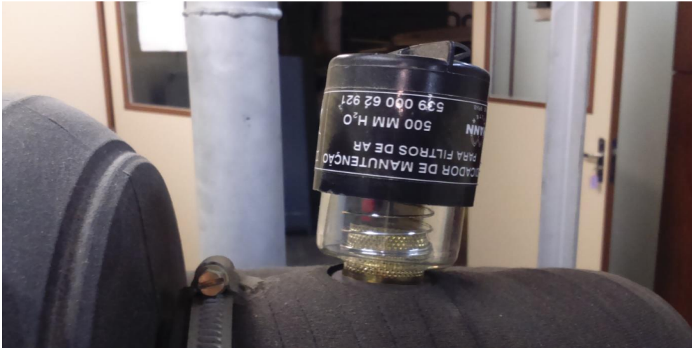
Figura 37 - Indicador de manutenção do filtro de ar Fonte: Autor (2015)
