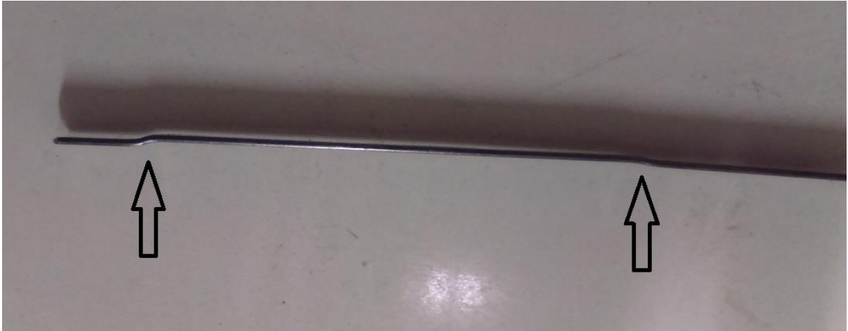
Figura 35 - Limites da vareta de inspeção do óleo lubrificante Fonte: Autor (2015)
