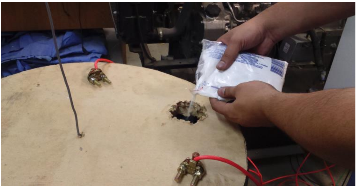
Figura 27 Adição de sal para simulação de carga Fonte: Autor (2015)
