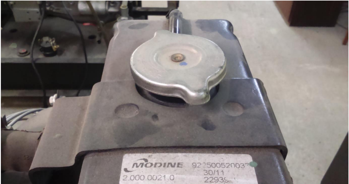
Figura 33 - Tampa do reservatório do radiador Fonte: Autor (2015)
