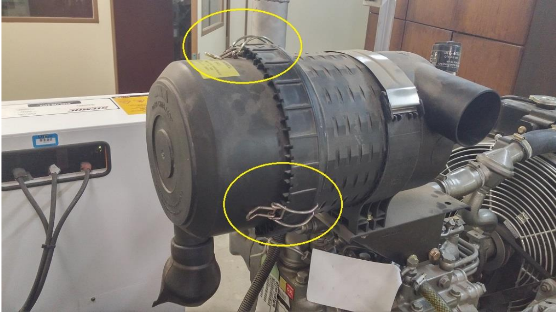
Figura 63 - Indicação das presilhas do compartimento do filtro de ar
