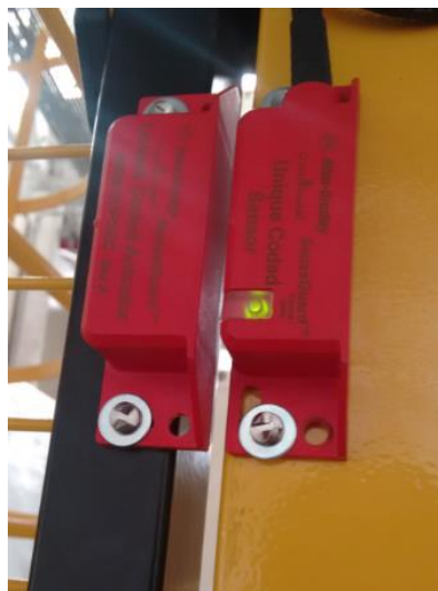
Figura 15 - Chave RFID instalada.
