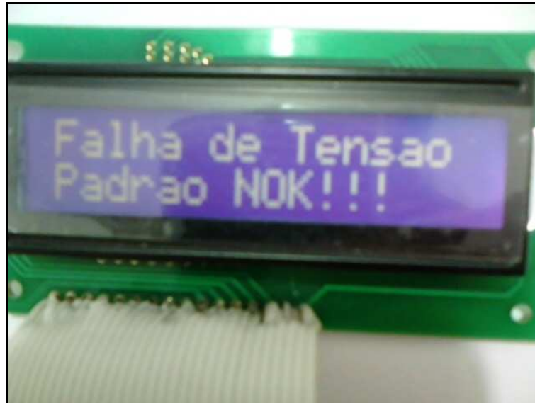
Figura 24 – Mensagem de erro mostrada quando a tensão não se estabiliza dentro dos valores especificados. Fonte: A autoria própria.
