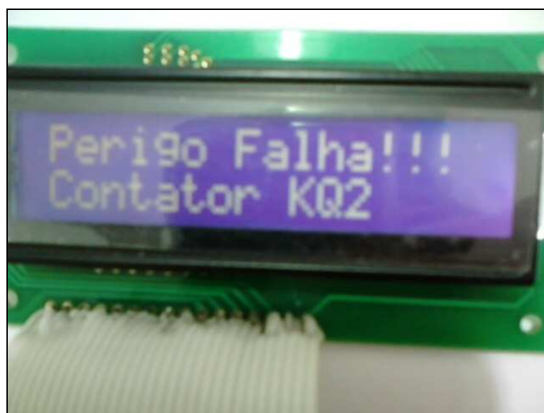
Figura 27 – Mensagem no display LCD indicando o contator que apresenta falha. Fonte: Autoria própria.
