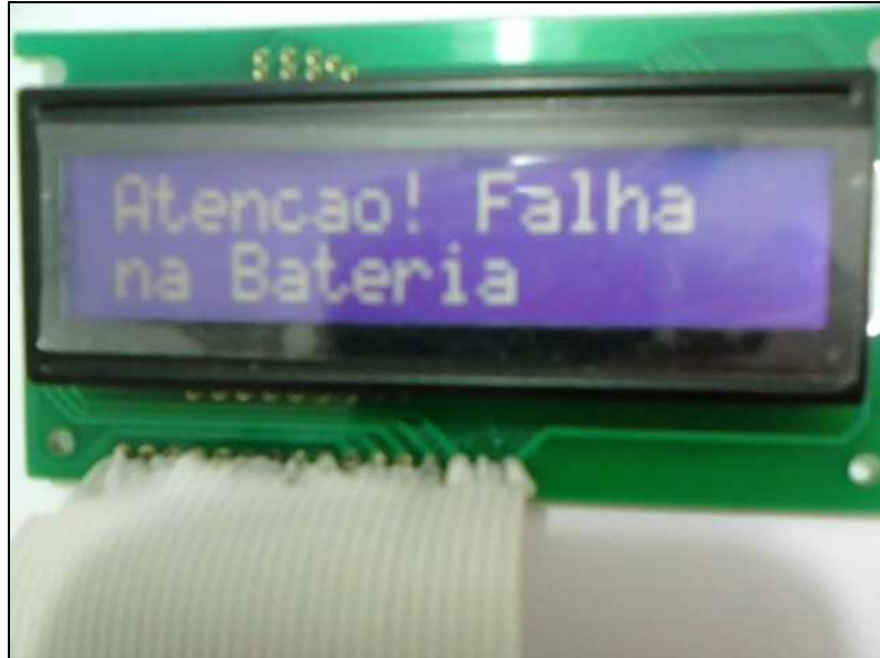
Figura 30 – Mensagem de erro indicando bateria com defeito. Fonte: Aatoria própria.
