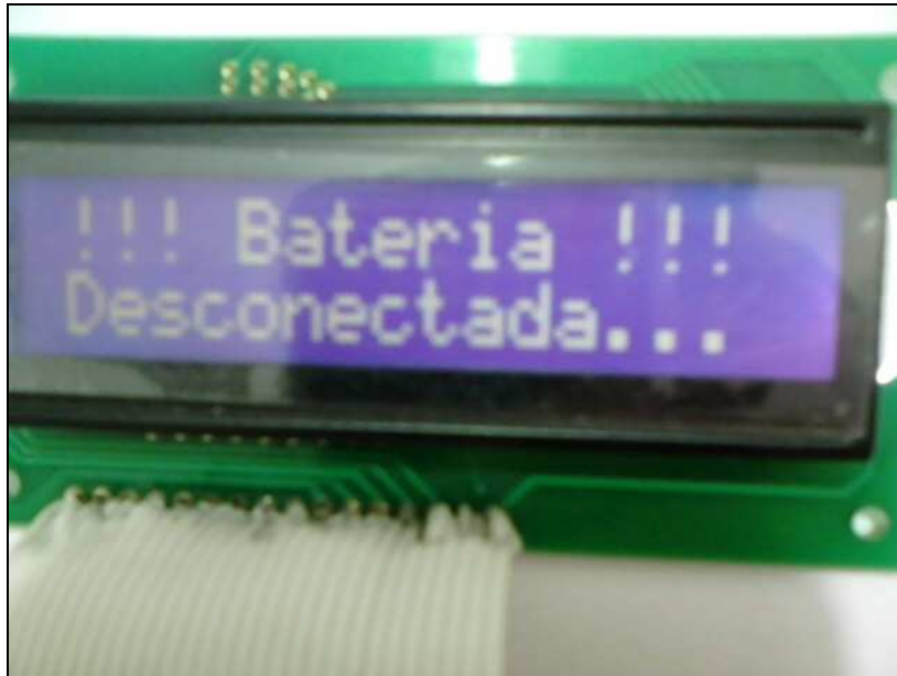
Figura 29 – Mensagem de erro indicando a bateria desconectada. Fonte: Autoria própria.
