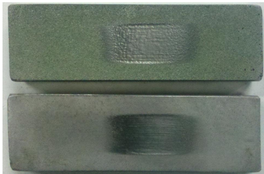
Figura 40 – Desgaste em dois corpos de prova. Fonte: Autoria própria.
