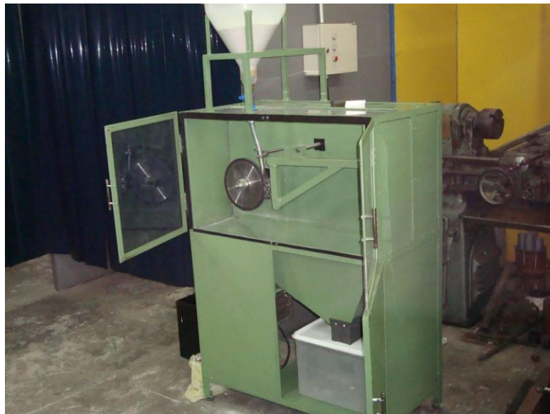
Figura 2 - Abrasômetro Roda de Borracha a ser automatizado. Fonte: Baratieri, Franchin e Moletta (2009, p.111).
