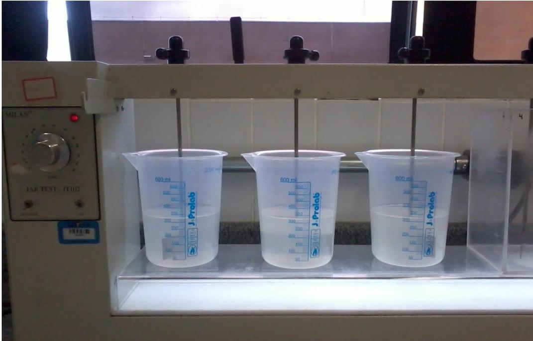
**Figura 19: Ensaio de coagulação/floculação/sedimentação em Jar Test**
