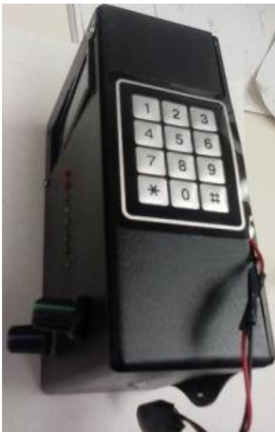
Figura 5- Teclado do Spirofeed com botão de acionamento de gravação "*" do esforço do usuário. Fonte: Própria.
