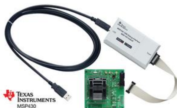
Figura 6- Kit de desenvolvimento MSP-FET430U64. A caixa branca é a interface JTAG. A placa é um soquete de inserção de programação do microcontrolador.
