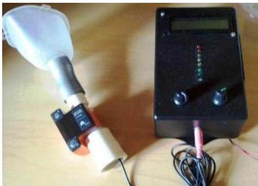
Figura 1- Foto do Spirofeed que fornece a resposta de biofeedback , acoplado à máscara e ao capnômetro que mede a concentração de CO 2 .
