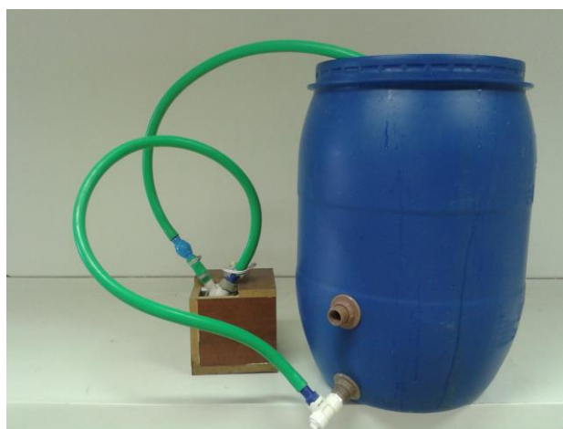
Figura 8. Imagem da bomba d'água com tambor plástico utilizada para transportar o efluente sintético aos sistemas de tratamento.
