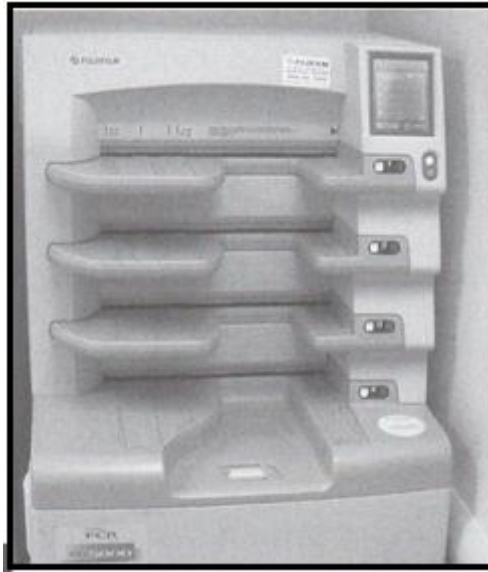
Figura 1 - Leitora de Placas de Imagens da Fuji. Fonte: CARTER e VEALÈ, 2008.
