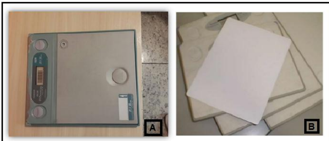
Figura 12 - (A) Cassete FUJI e (B) Placas IPs. Disponível em: http://pt.slideshare.net/LiaLia4/prinpios-de-aquisio-da-imagem-cr Acesso: 03/01/17.
