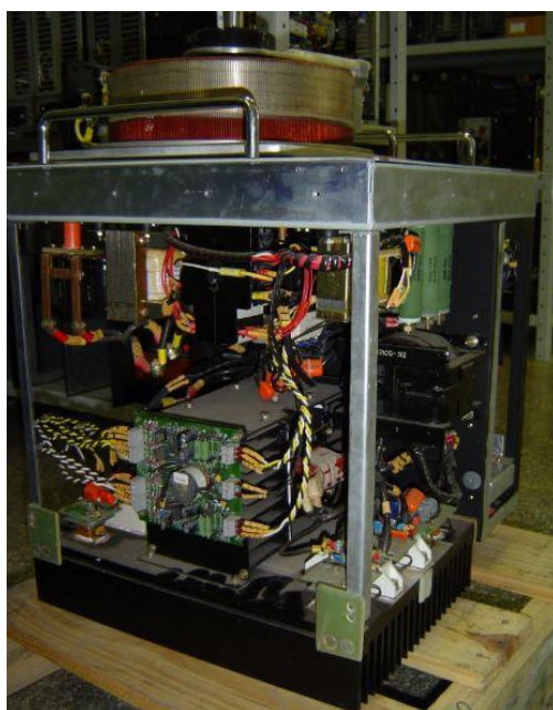
Figura 16- Retificador 100A da Sisten Sistemas de Energia. Fonte: Autorial própria.
