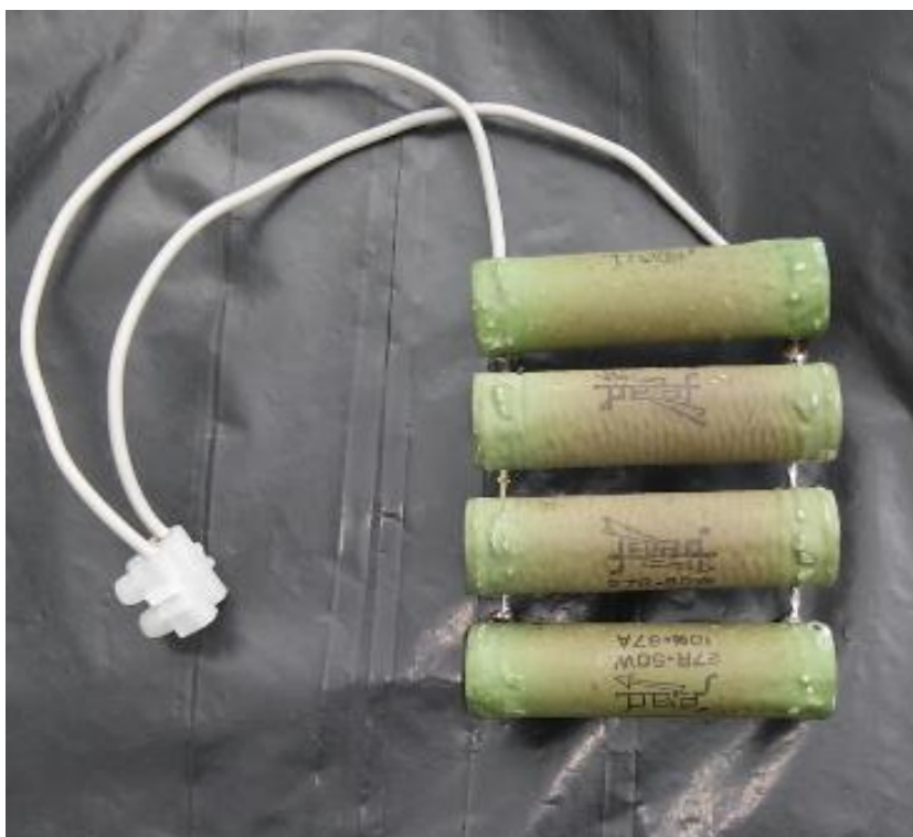
Figura 40- Carga resistiva utilizada para simular os consumidores do sistema retificador
