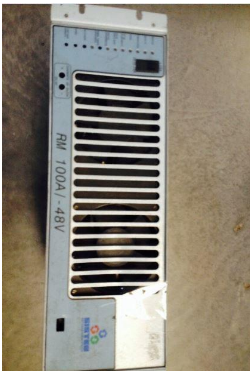
Figura 17- Retificador 100A da Sisten de Energia. Fonte: Autoria própria.
