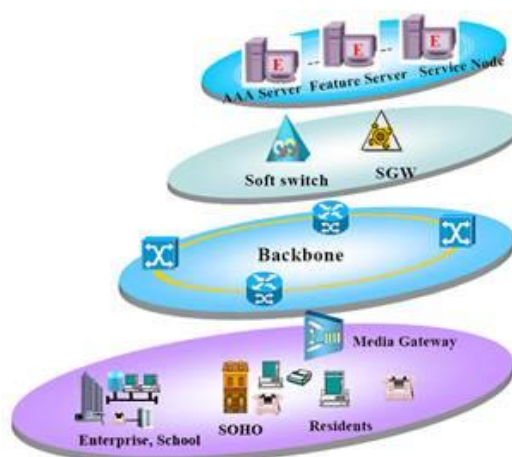
Figura 10 - Modelo básico de arquitetura NGN Fonte: CASTRO, 2005.
