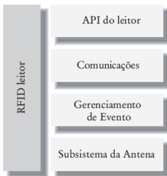
Figura 15 – Componentes lógicos de um leitor. Fonte: Glover; Bhatt, 2007.
