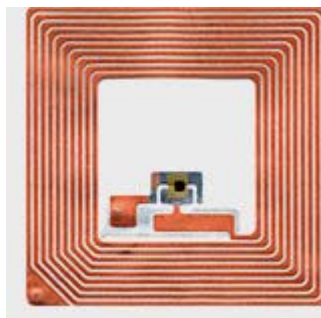
Figura 12 - Layout básico de uma tag Fonte: RFID Systems - Inventory and Asset Tracking from RVB Systems Group
