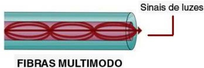
Figura 12 – Modo de propagação Multimodo de Índice Gradual.
