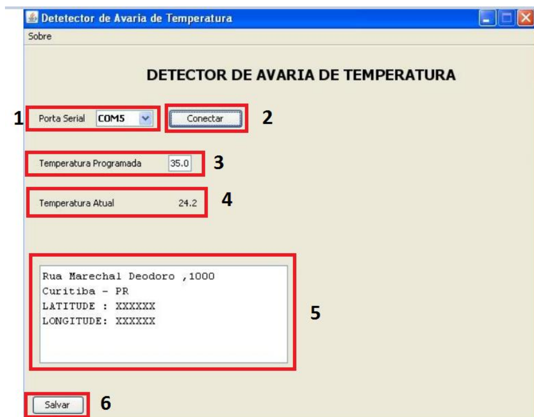
Figura 13 – Interface de controle de temperatura Fonte: autoria própria (2014)
