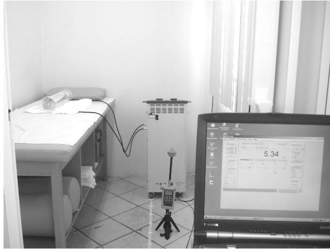
Figura 9: Posicionamento típico dos equipamentos durante o ensaio.
