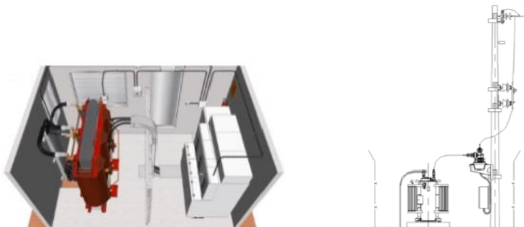
Figura 13: Centros de Transformação com estrutura externa ao aerogerador.
