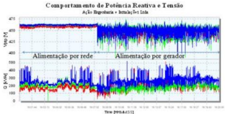
Figura 28 – Comportamento da tensão e potencia reativa
