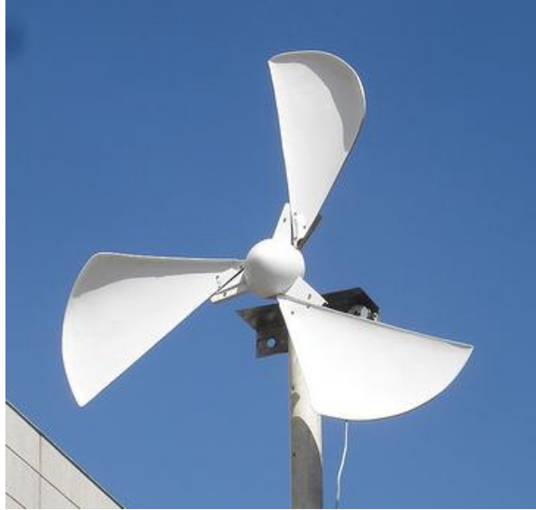
Figura 25 – Gerador eólico com hélice de pás deformadas
