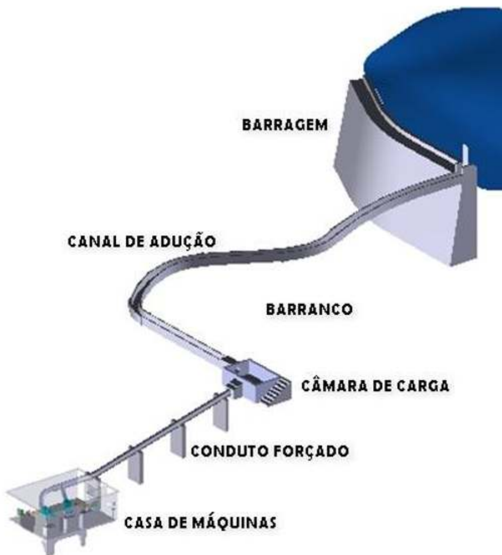
Figura 43 - Câmara de carga e conduto forçado - MCH de Rio Branco do Sul Fonte: Coelho e Xavier, 2015
