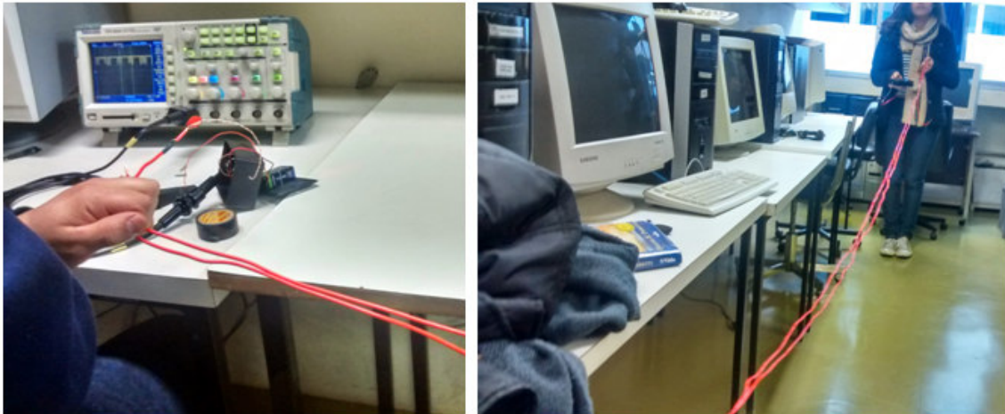
Figura 50: Medição de tensão no par de 5 metros - situação G. Fonte: Autoria Própria.
