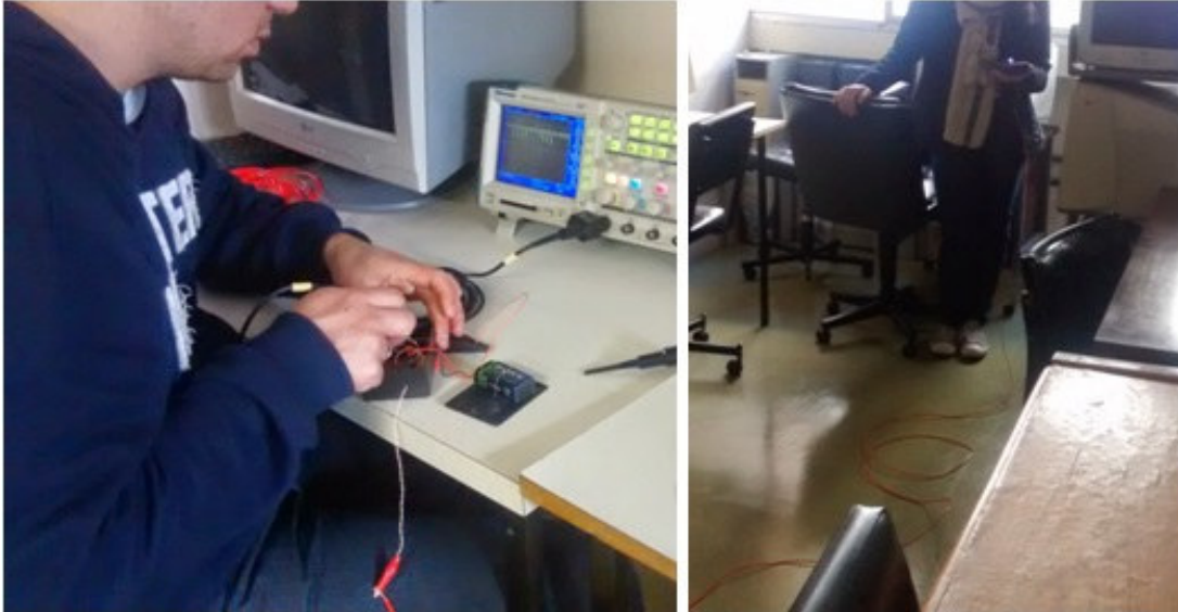
Figura 37: Medição de tensão no cabo de 10m esticado. Fonte: Autoria Própria.
