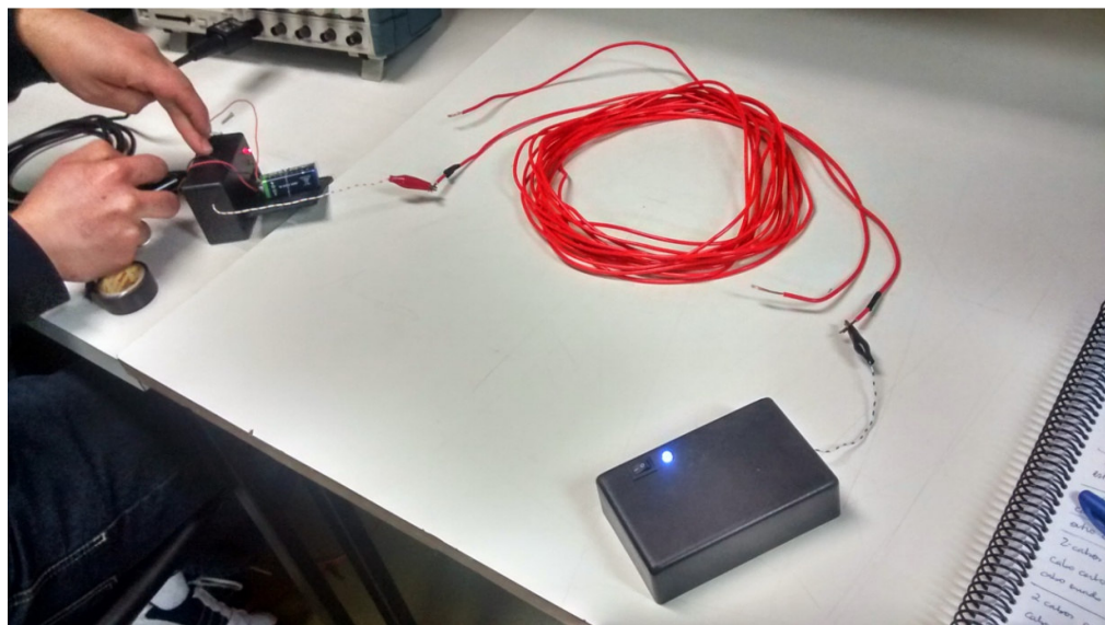
Figura 47: Medição de tensão no par de 5 metros - situação E. Fonte: Autoria Própria.
