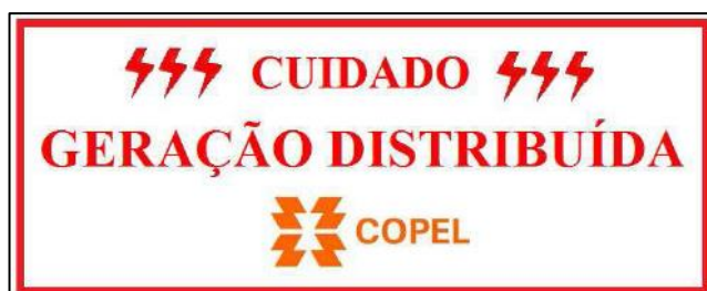
Figura 11 – Aviso da COPEL para indicar geração distribuída no local Fonte: NTC 905200, 2014
