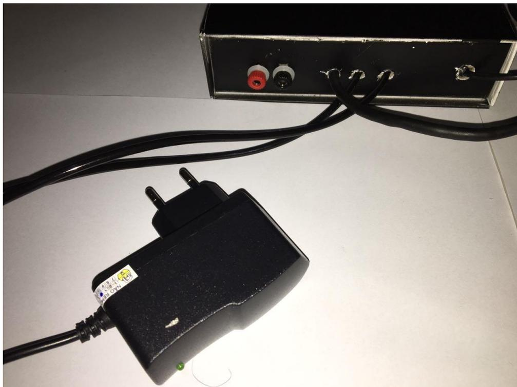
**Figura 35 - Alimentação sensor de rotação.**
