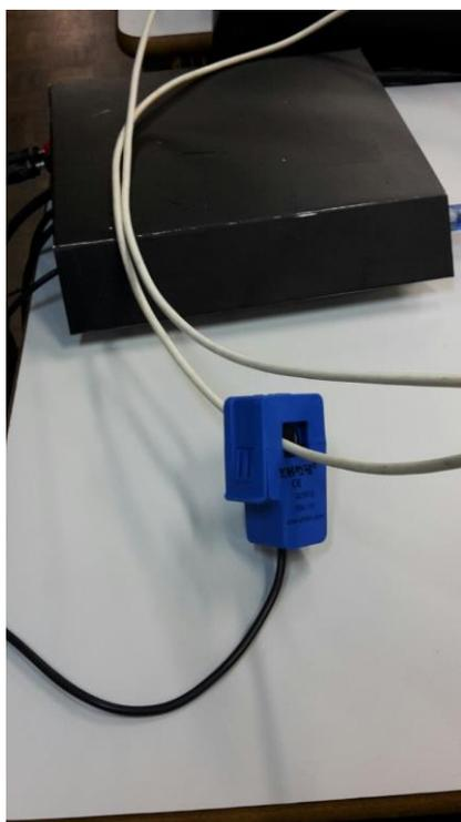
**Figura 21 - Fixação sensor de corrente.**
