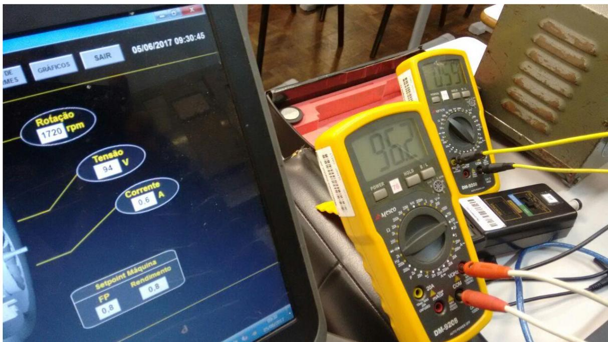
**Figura 38 - Comparação supervisorio com multímetro.**
