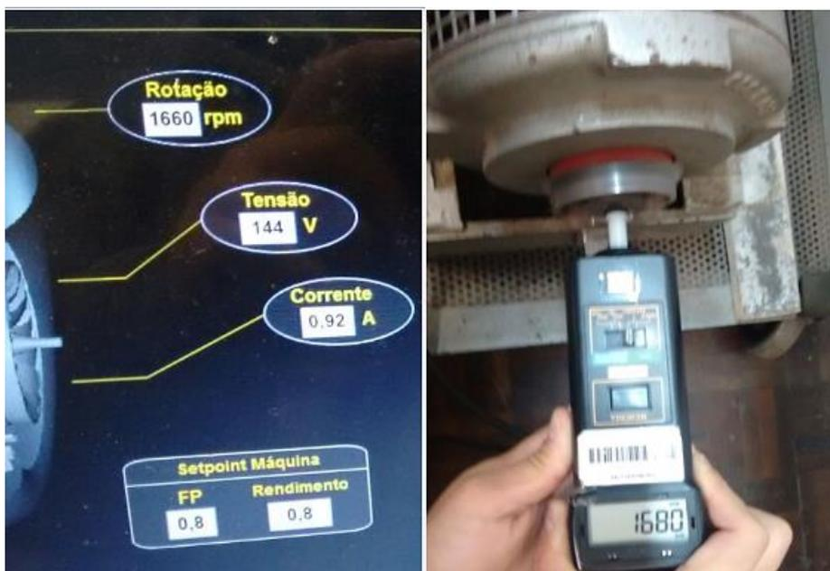
**Figura 40 - Comparação supervisorio e tacômetro.**
