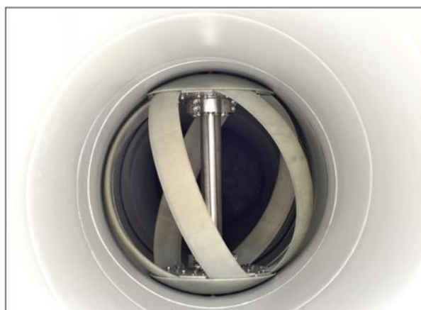
Figura 9 – Design da turbina LPPS no interior de adutora
