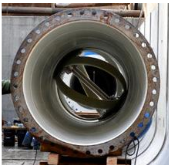
Figura 8 – Turbina LPPS no interior de adutora
