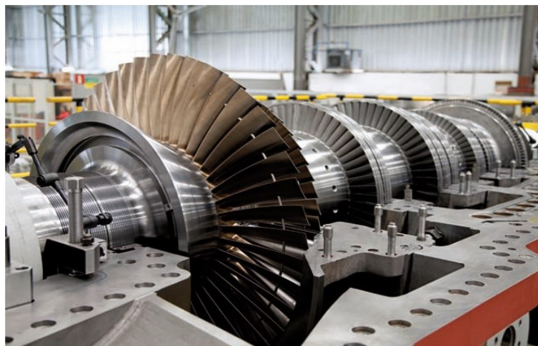
Figura 2.4: Turbina térmica com vários estágios de pressão em eixo único. Fonte: Autoria própria.
