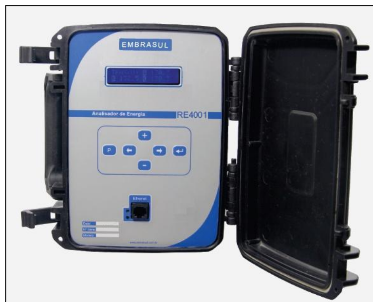
Figura 11 - Analisador de energia Embrasul RE4001. Fonte: EMBRASUL, 2015.
