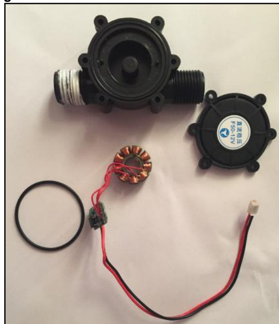
Figura 45. Segunda fase da desmontagem do gerador.
