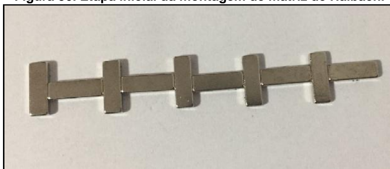
Figura 50. Etapa inicial da montagem de matriz de Halbach.
