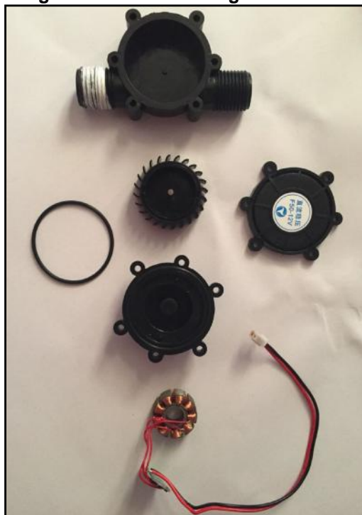
Figura 38. Detalhes do gerador F-50.
