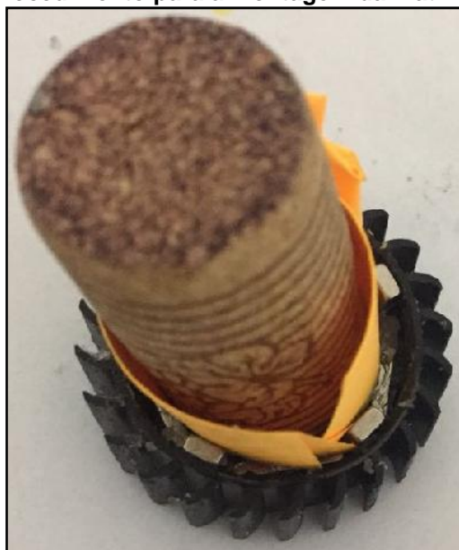
Figura 53. Procedimento para a montagem da matriz de Halbach.
