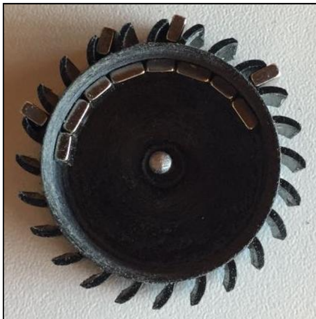
Figura 57. Matriz de Halbach montada com ímas de 5 x 4 x 2 mm.
