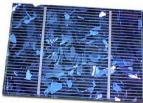
Figura 6. Célula fotovoltaica de silício policristalino.
