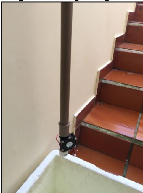
Figura 39. Montagem do gerador.
