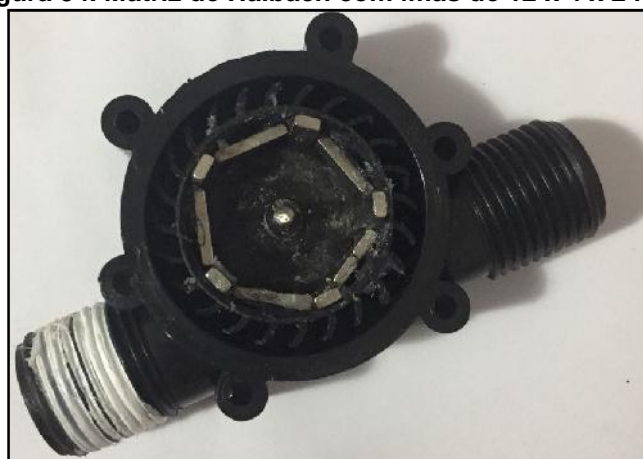
Figura 54. Matriz de Halbach com ímas de 12 x 4 x 2 mm.
