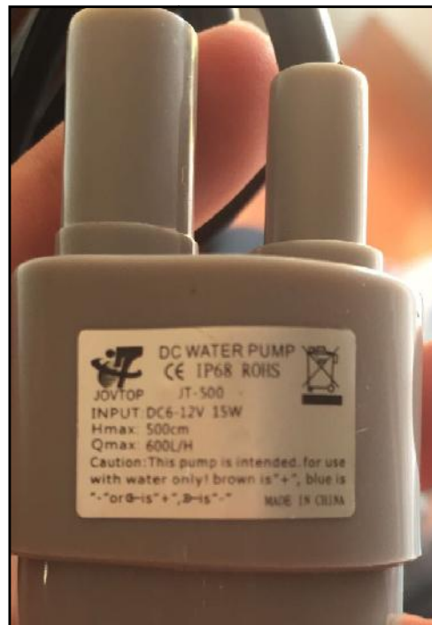
Figura 32. Dados de placa da bomba JT-500.
