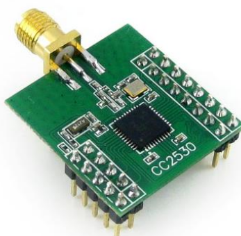
Figura 6 – Módulo de Comunicação com Chip CC2530 Fonte: Waveshare (2015).
