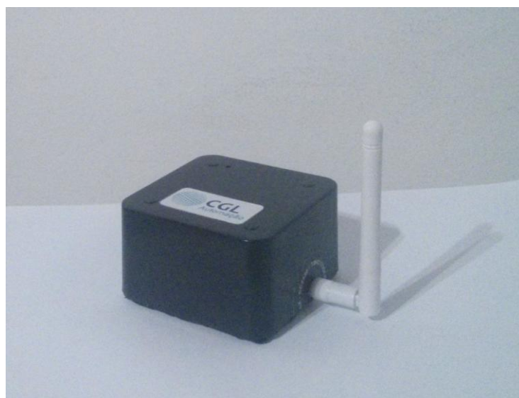
Figura 11 – Módulo Coordenador ZigBee Fonte: Autoria própria.
