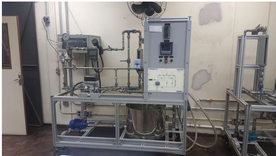
Figura 13: Planta de controle de vazão do laboratório B004.
