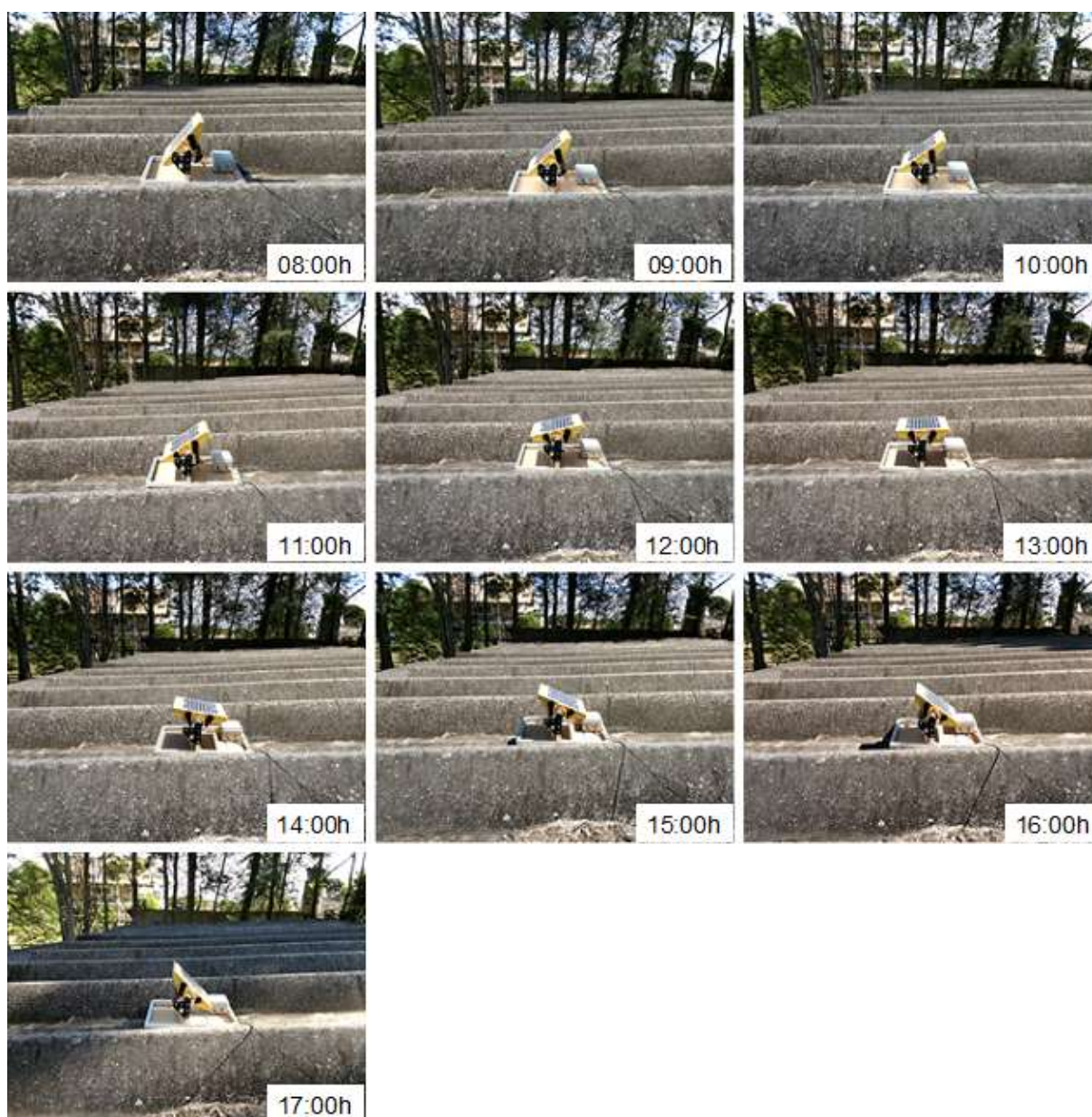
Figura 48 — Resultado do teste em condições reais, com dia ensolarado.
