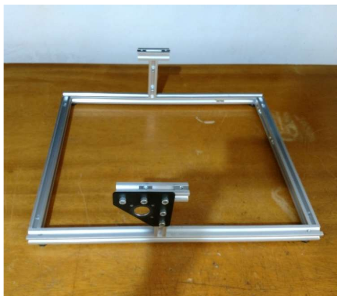
Figura 29 — Estrutura de sustentação do seguidor.
