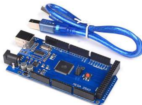
Figura 23 — Arduino MEGA e cabo de comunicação USB.
