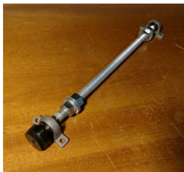
Figura 30 — Eixo de rotação da placa solar e acessórios.
