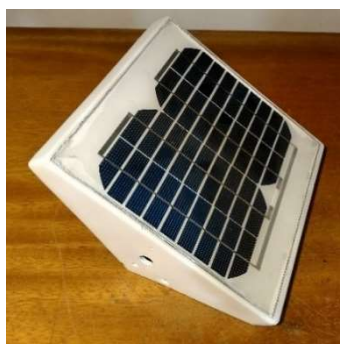
Figura 31 — Placa solar com suporte modificado para acoplar-se ao eixo do seguidor.
