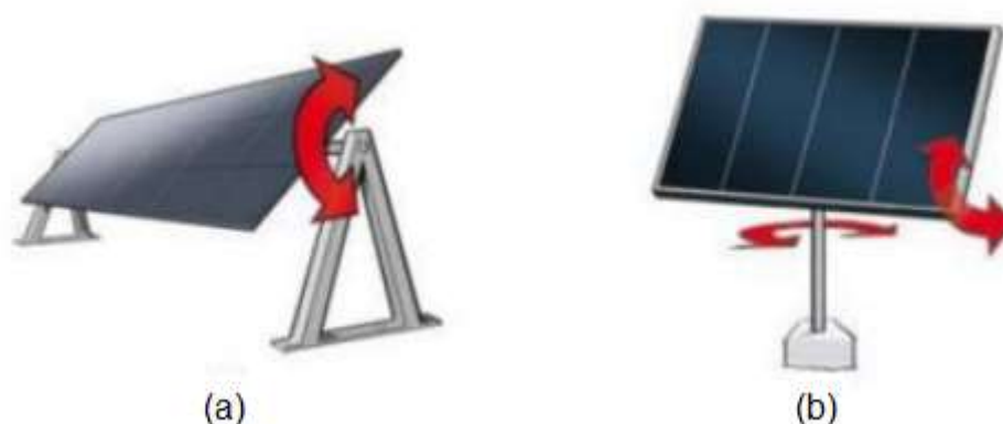
Figura 18 — Tipos de seguidores solares: (a) de um eixo e (b) de dois eixos.
