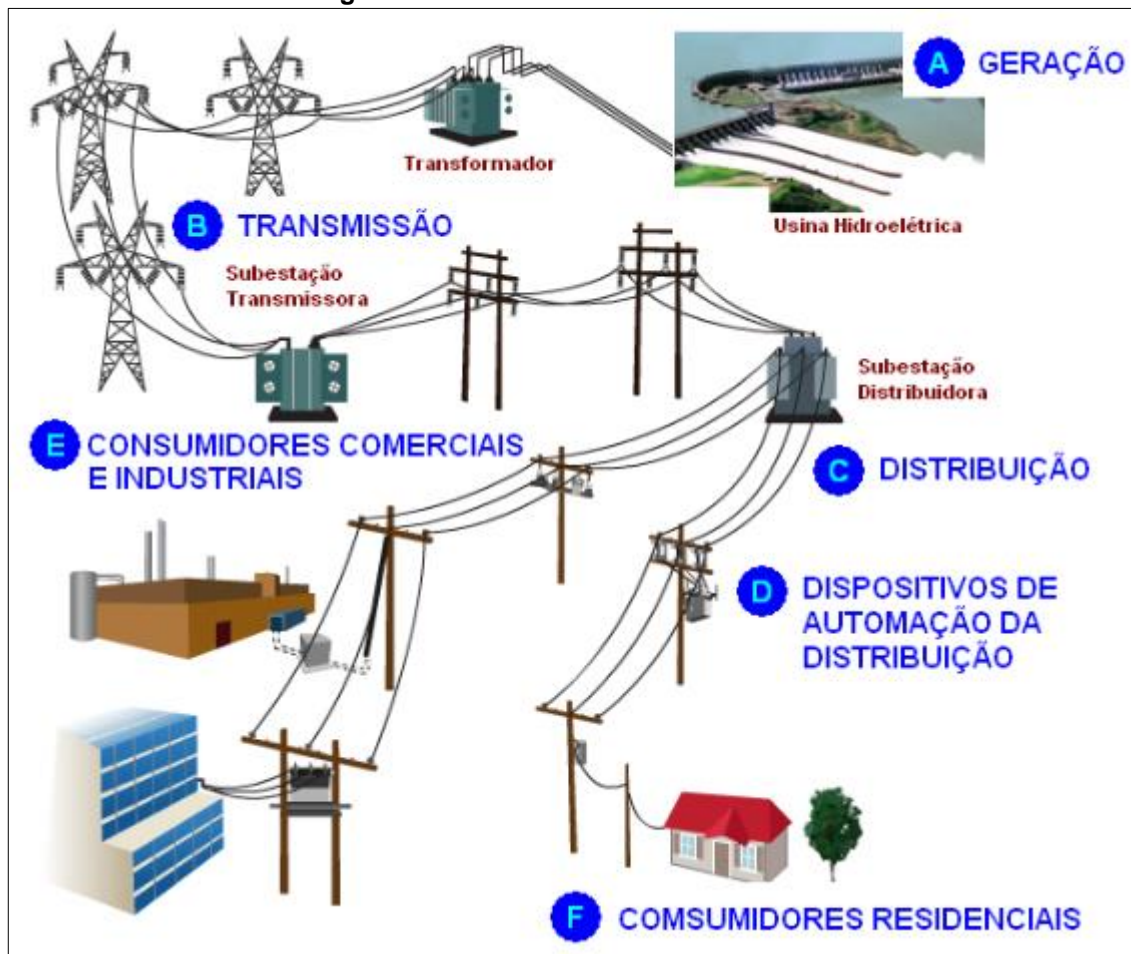
Figura 1.1 - Sistema Elétrico de Potência
