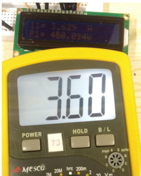
Figura 25 - Medição do circuito 1 na calibração dos sensores.
