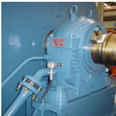
Figura 15 – Mancal de bucha com circulação forçada de óleo
