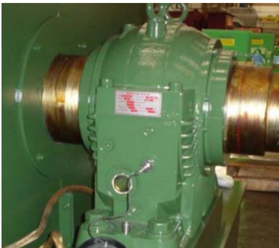
Figura 14 – Mancal de bucha com refrigeração natural
