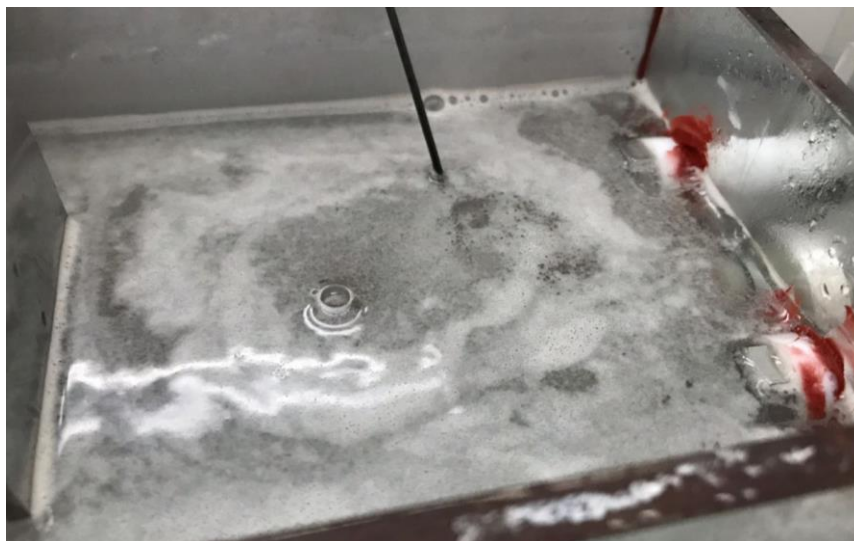
Figura 27 - Bolhas na superfície do fluido eletrolítico
