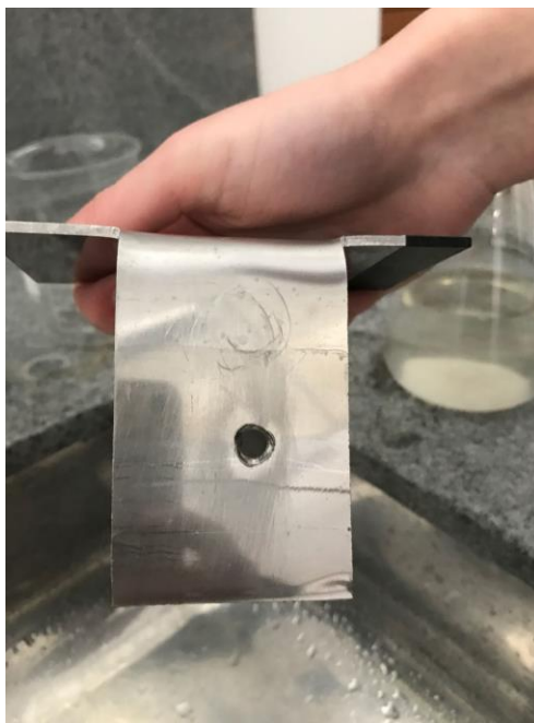
Figura 20 - Contra eletrodo livre de deposição em sua superfície
