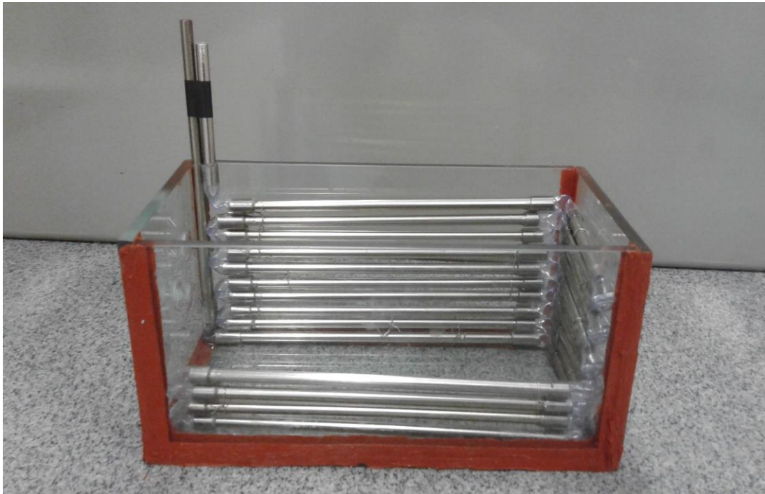
Figura 18 - Sistema original de resfriamento por serpentina.
